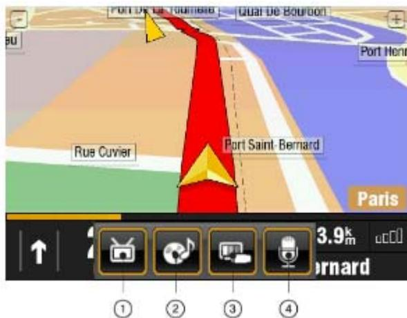
Когда Вы нажмете на кнопку спереди корпуса при включенной программе для навигации, Вы включите меню PIP. Данная функция позволяет вертикально разделить экран на 2 части и одновременно показывать экран навигации и один из трех дополнительных: Вход AV, Аудио проигрыватель, камера заднего обзора.
