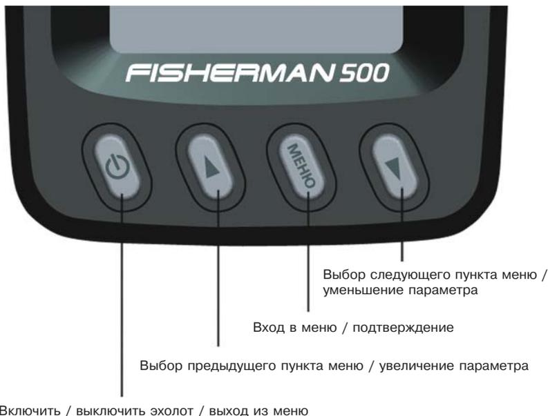
При нажатии на кнопку эхолот издает звуковой сигнал. Это означает, что система приняла команду.
